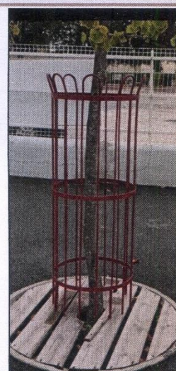
Fabrication d'un corset métallique arbre école
